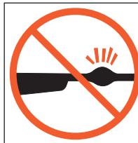
Entreposer et transporter la carabine à air comprimé de façon à éviter que la saleté ou la poussière ne s'accumulent dans les mécanismes de fonctionnement. Nettoyer et lubrifier la carabine à air comprimé en suivant les instructions de cette notice, et après chaque utilisation, pour prévenir la corrosion, les dommages au canon et l'accumulation d'impuretés.
