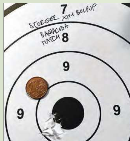
Cinque colpi in 16 mm a 50 metri in appoggio anteriore, con cannocchiale Konus Armada ▲ 6-24x56 e pallini H&N Baracuda match del peso di 2 grammi
